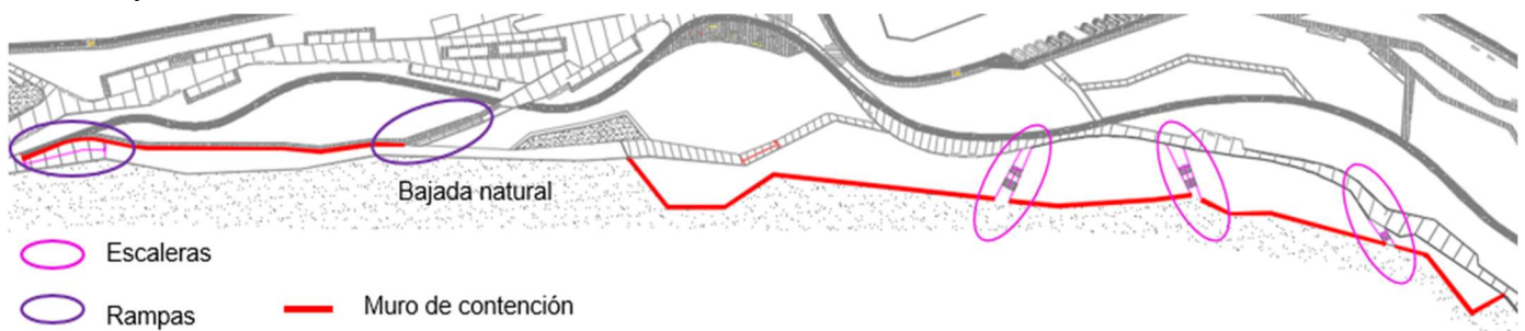
Proyecto municipalidad – Muros de contención y bajadas
