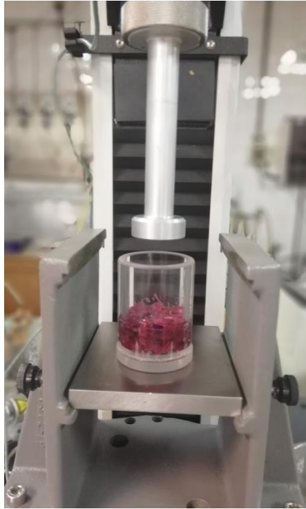
Figura 23: Análisis de la textura de los productos fermentados mediante un texturómetro Universal de Testeo INSTRON equipado con un vástago de cabezal circular.
