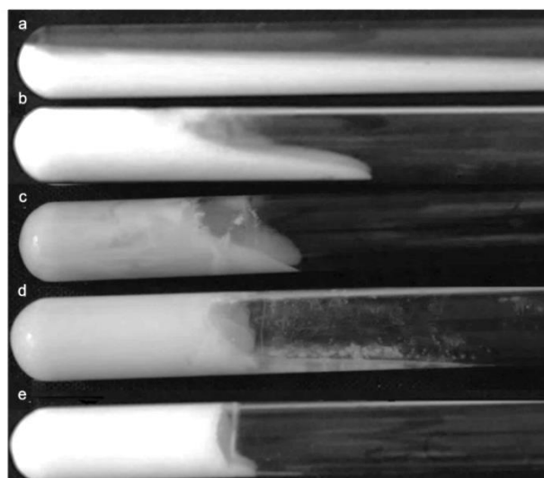
Figura 36: Efecto de EPS producidos por la cepa Ln. mesenteroides ssp. joggajibkimchii RCTw1.1 en la solidificación de la leche sin lactosa. a: control negativo; b: 3%; c: 6%; d: 9% y e: 12% de sacarosa.
