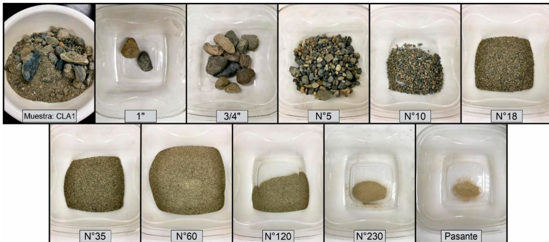
Figura 1. Muestra correspondiente al CLA1. Bandejas individuales correspondiente a la fracción de la muestra retenida en cada uno de los tamices utilizados luego del análisis granulométrico en seco.
