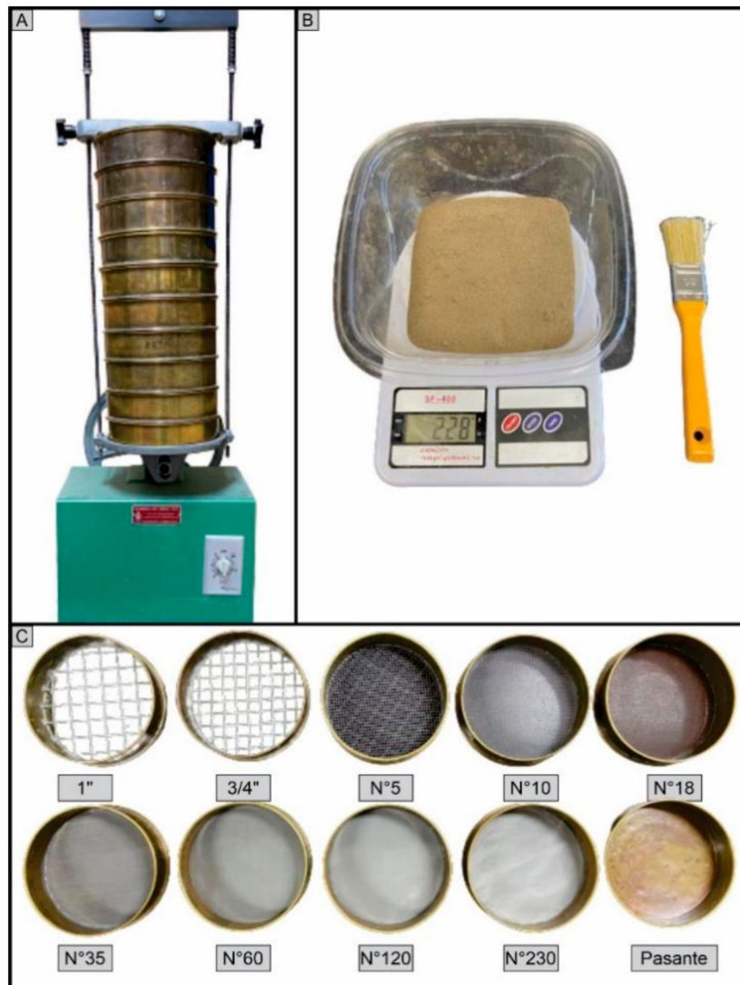
Figura 11. A) Equipo de ro-tap marca Humboldt Mfg. , modelo H-4330 . B) Balanza digital marca Electronic Kitchen scale , modelo SF-400 y bandejas individuales de plástico (polietileno). C) Tamices desmontables utilizados conformados por una estructura circular de bronce y un mallado interno de acero inoxidable.
