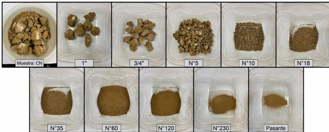
Figura 37. Muestra correspondiente al CN. Bandejas individuales correspondiente a la fracción de la muestra retenida en cada uno de los tamices utilizados luego del análisis granulométrico en seco.
