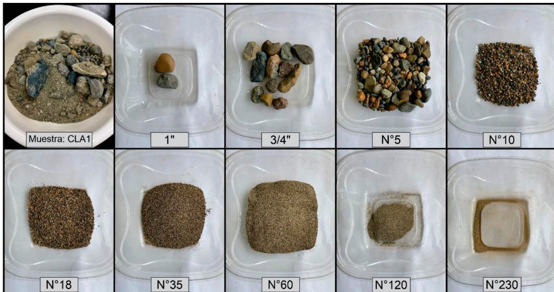
Figura 5. Muestra correspondiente al CLA1. Bandejas individuales correspondiente a la fracción de la muestra retenida en cada uno de los tamices utilizados luego del análisis granulométrico en húmedo.
