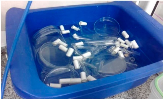
Figura 18. Recipiente de descontaminación de materiales de cultivo con solución de hipoclorito de sodio.
