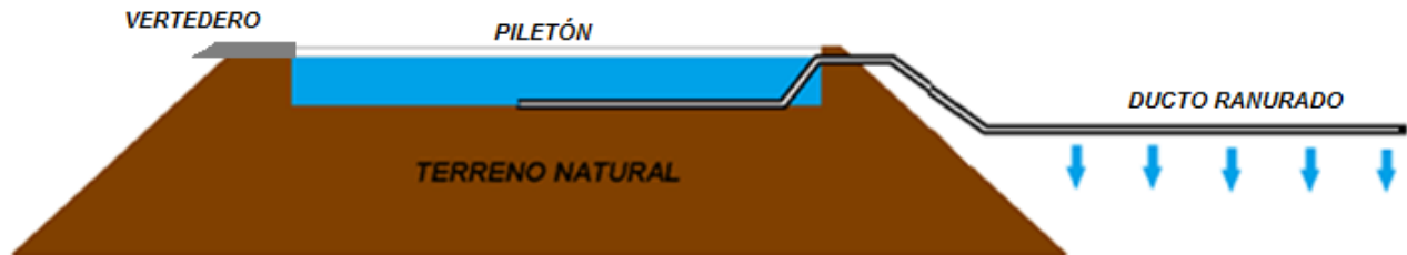
Gráfico 7: Vista en corte del piletón en locación petrolera con sistema de sifonaje.
