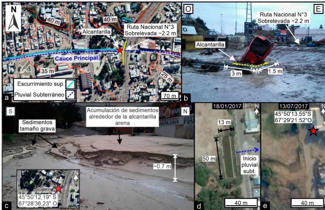
Figura 30. a) Imagen satelital de Google Earth™ de la zona más afectada de Km. 3 por inundaciones. Se observa la posición del cauce principal, la alcantarilla y la Ruta Nacional N°3. El escurrimiento se da de forma superficial y subterránea hasta la alcantarilla, luego de ésta, se da a través de un pluvial subterráneo. b) Alcantarilla obstruida por un vehículo arrastrado por el flujo de agua. La Ruta Nacional N°3 se posiciona aproximadamente 2.2 m por encima de la alcantarilla. c) Depósitos de sedimentos alrededor de la alcantarilla. Predomina la arena fina a muy fina con respecto a las granulometrías tamaño grava. d) Imagen satelital de Google Earth™ de la pileta de decantación del día 18/01/2017, antes de la tormenta. e) Imagen satelital de Google Earth™ de la pileta de decantación colmatada del día 13/07/2017, después de la tormenta.
