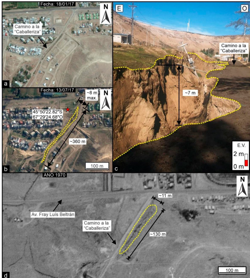
Figura 23. Se observa la cárcava generada por el temporal del 2017 sobre el camino a la “Caballeriza”. a) Imagen satelital de Google Earth™ antes del temporal (18/01/17). b) Imagen satelital de Google Earth™ posterior al temporal (13/07/17). c) Fotografía de la cárcava donde puede observarse la profundidad de la incisión vertical debido a la erosión hídrica. d) Fotografía aérea vertical del año 1970 (IGM) donde se observa una cárcava a pocos metros del camino a la “Caballeriza”.
