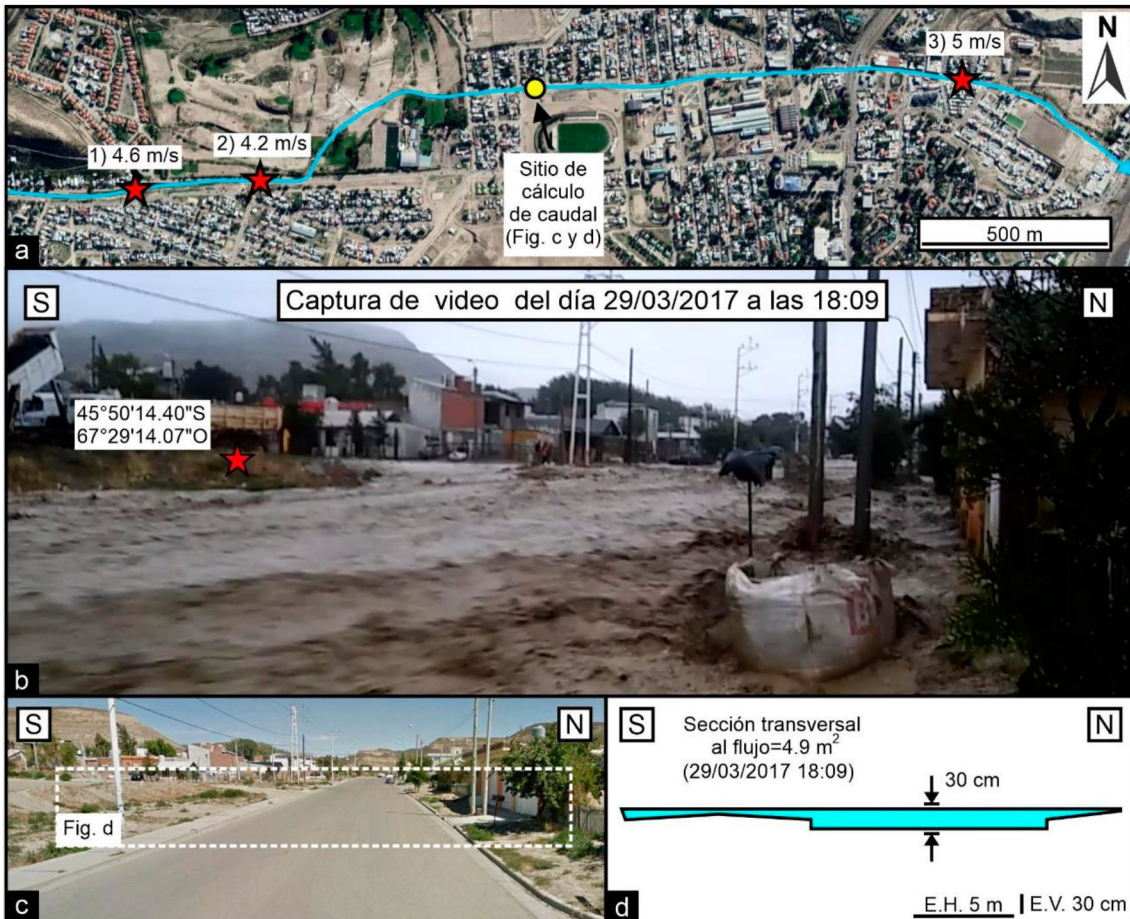
Figura 14. a) Se observa la trayectoria del cauce principal y el cálculo de velocidad de flujo en distintos sectores a través del método del flotador (1, 2 y 3). b) Captura de video del flujo de agua sobre la calle Petrolero San Lorenzo el día 29/03/17 a la hora 18:09, apenas iniciada la tormenta. c) Calle Petrolero San Lorenzo antes de la tormenta. d) Sección transversal del flujo de agua del día 29/03/17 a la hora 18:09.
