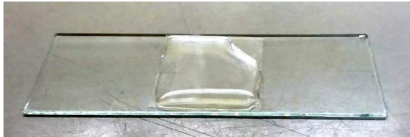
Figura 1.9. Porta objeto con gel de agarosa con 5% MgCl_2 , que tiene propiedades anestésicas, para inmovilizar y fotografiar in vivo a las larvas.
