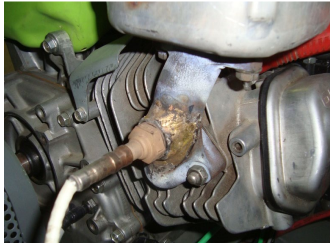
Conducto de escape con sonda lambda.
