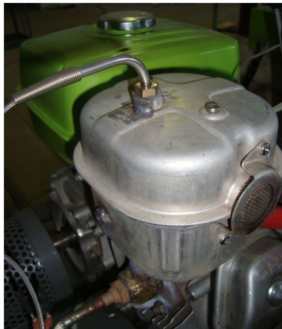
Termocupla colocada en el silenciador del escape.
