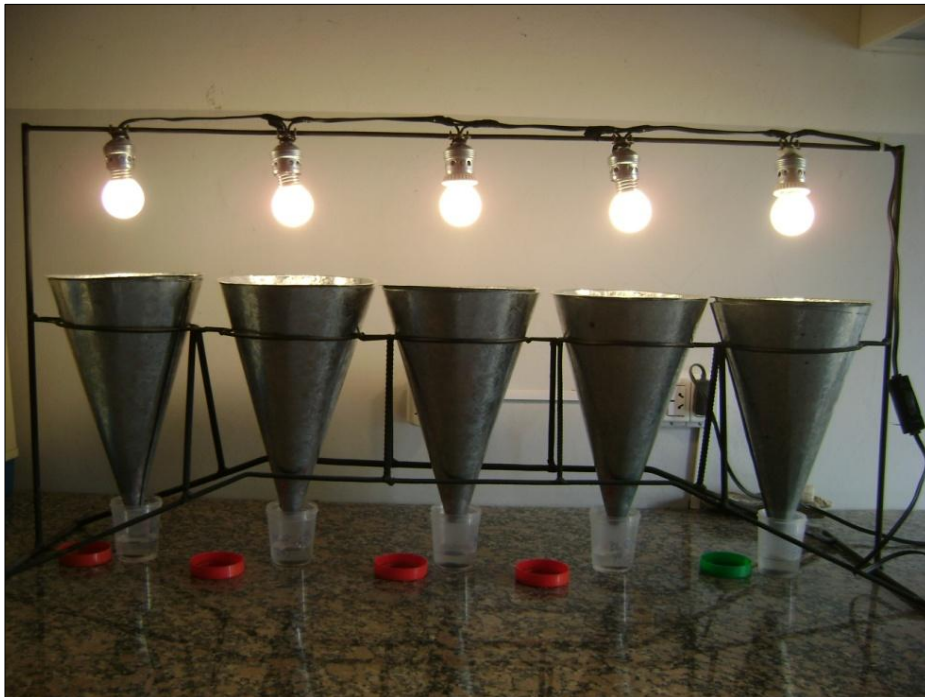
Figura 7. Detalle de los embudos Berlese, en su soporte, con las muestras y la luz encendida.
