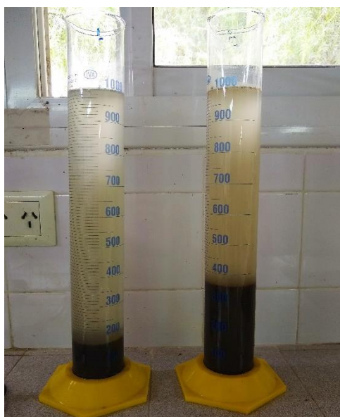
Figura 29: Probetas graduadas donde se realiza la determinación de sólidos sedimentables.
