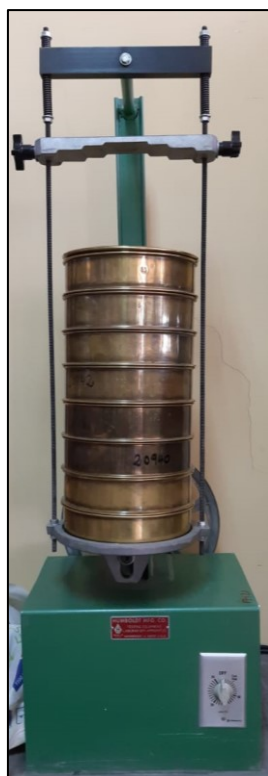
Figura 4.5 | Ejemplo de tamizadora mecánica con tamices.
