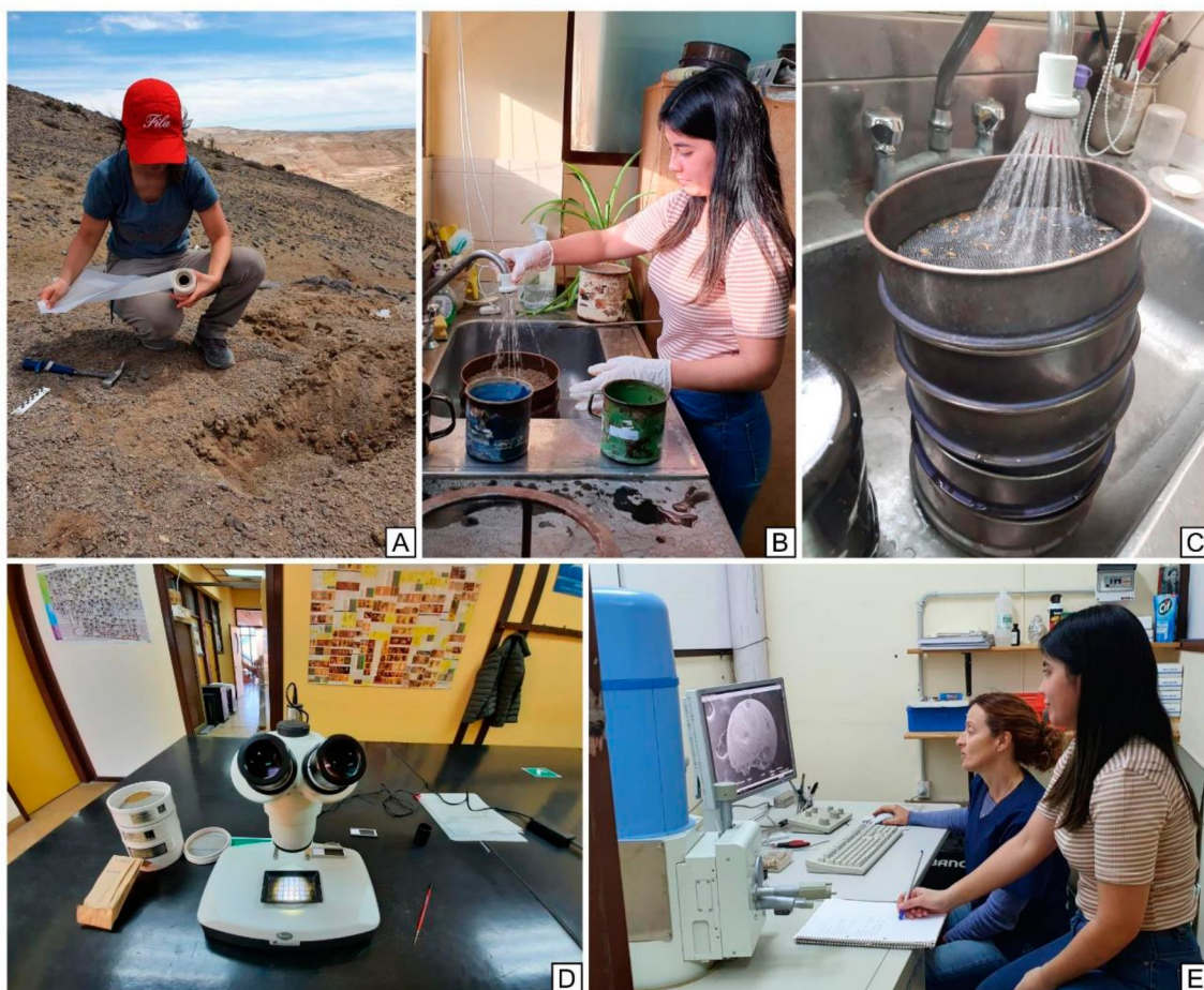
Figura 2. Síntesis de las tareas de campo y laboratorio realizadas. A) Recolección de muestras del perfil en campo con bolsas de polietileno. B y C) Lavado de muestras para su correcta desagregación. D) Lupa binocular utilizada en laboratorio. E) Fotografiado en el Microscopio Electrónico de Barrido de especímenes seleccionados.
