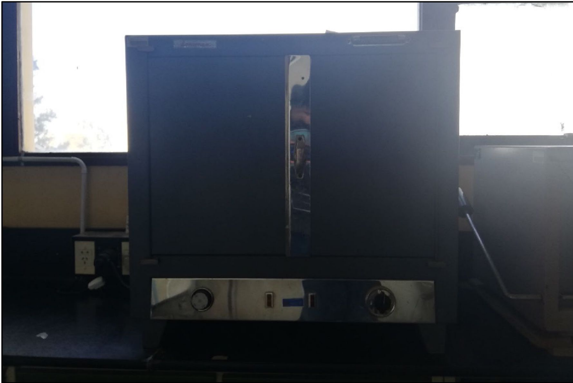
Figura III.3. Acondicionamiento de las muestras, estufa de secado a 65°C.
