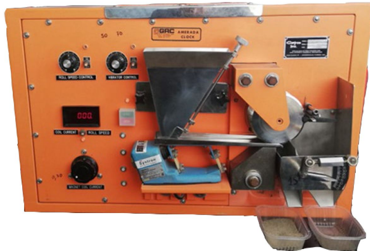
Figura III.7. Equipo de separación magnética Magnet-Lift MLH.
