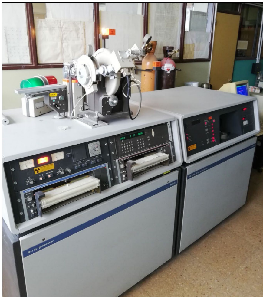
Figura III.12. Equipo de difracción y fluorescencia de rayos x del laboratorio "Lic. Arturo Canero".
