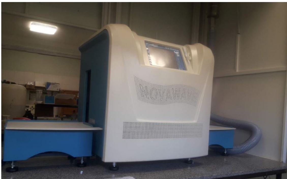
Figura III.25. Digestor “Novawave” en laboratorio de Épsilon.
