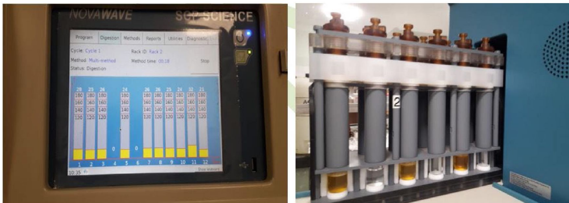
Figura III.24. Cápsulas de digestión de cuarzo utilizados para la digestión por microondas.
