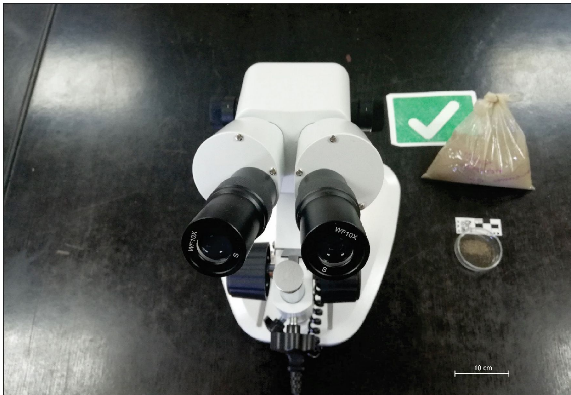
Figura III.6. Lupa binocular utilizada para la descripción mineralógica a nivel macro.
