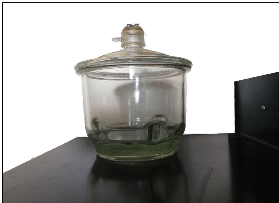
Figura III.20. Desecador de vidrio con etilenglicol en el fondo y sobre un frasco de Petri los portaobjetos con muestra.
