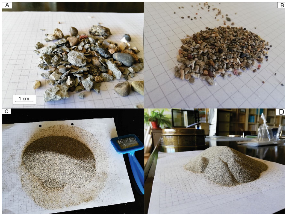
Figura III.5. Fraccionamiento sobre las distintas muestras A) M8 tamiz #18 B) M13 tamiz #35 C) M14 tamiz #60 D) M9 tamiz #120.
