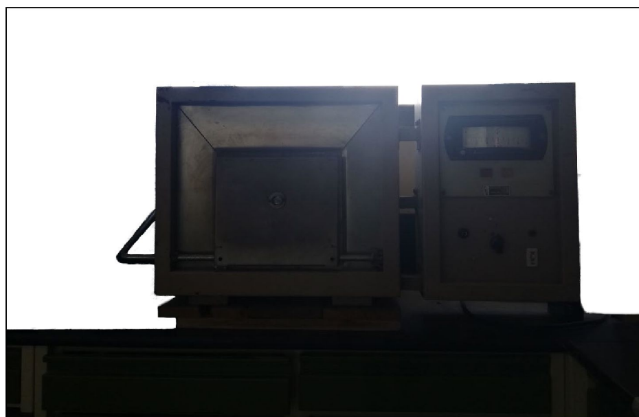
Figura III.21. Mufla para calcinar la muestra a 550°C. Laboratorio UNSPJB.
